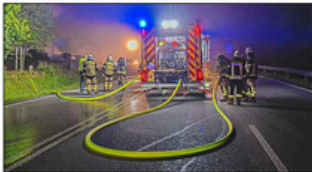
Für ausreichend Löschwasser sorgte eine Förderleitung, da eine einzige Hydrantenleitung nicht ausreichte.
